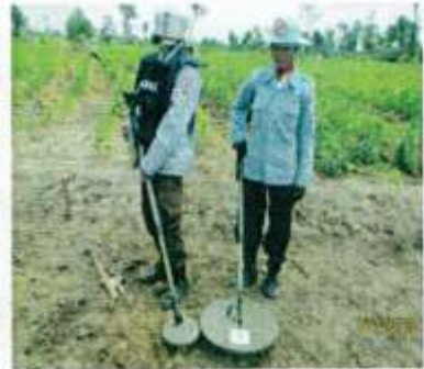
小さな探知機は地表から30cm 大きい探知機は地表から1mの 金属を検知できます
